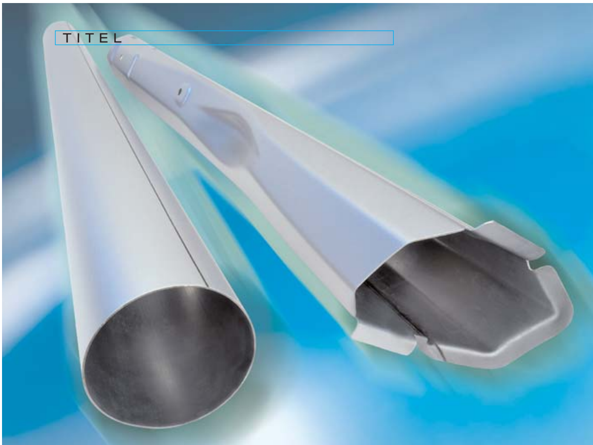
Moderne Mehrphasenstähle sorgen für hohe Energieabsorption und bieten gleichzeitig Potenzial zur Gewichtseinsparung. Aus den Vorprodukten links entstehen beispielsweise Längsträger für Autos. Rechts ein Abgaskühler aus Edelstahl für Dieselmotoren. Das System vermindert Stickoxid- und Partikelemissionen und verringert den Kraftstoffverbrauch.
