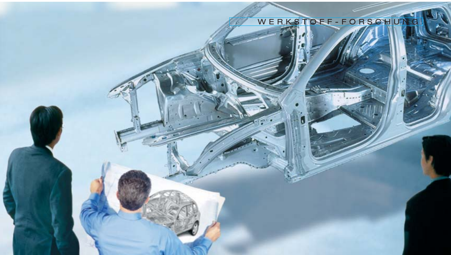
VW Touareg (im Bild) und Porsche Cayenne sind zurzeit die Fahrzeuge mit dem höchsten Anteil an modernen Mehrphasenstählen in der Rohkarosserie. Damit erreichen die Fahrzeuge Spitzenwerte bei Crashverhalten und Verwindungssteifigkeit trotz eines vergleichsweise geringen Rohbaugewichts von 392 Kilogramm.
