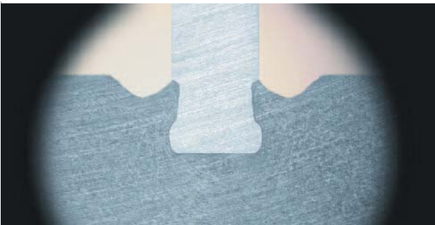
Die DAVEX-Verbindung entsteht in einem innovativen Rollfügeverfahren. Dabei wird das Profilmaterial direkt vom Coil zugeführt. Im Schliff (unteres Bild) wird der DAVEX-Verbindungs Aufbau sichtbar.
