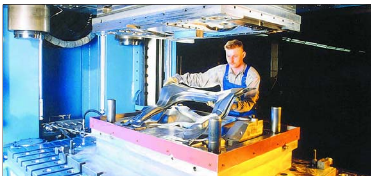
Eine Wasser-Öl-Emulsion vereinfacht den Prozess des Blechbiegens. Die Heilbronner Hydroformer bauen ihre Werkzeuge selbst FOTO: THYSSENKRUPP
